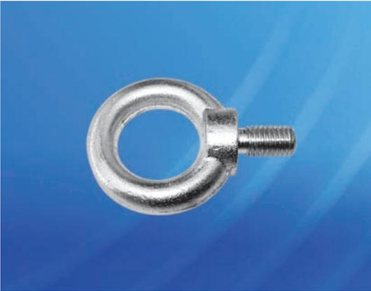
Предназначен для транспортировки шкафов с помощью крана. Легко монтируется в стальные закладные рамы, диаметр резьбы 12 мм. Предельно допустимая статическая нагрузка 200 кг при транспортировке под углом 60°
