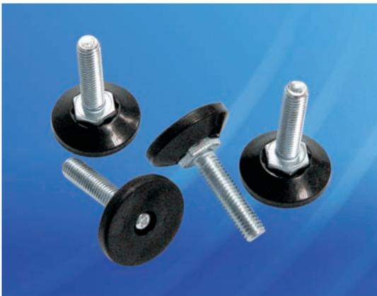
Предназначена для компенсации неровностей пола. Диаметр резьбы 12 мм, длина штыря для прямого ввинчивания 40 мм. Предельно допустимая статическая нагрузка 300 кг на опору
