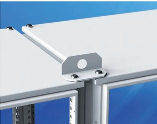
Предназначен для равномерного распределения силы подъема при транспортировке двух соединенных шкафов с помощью крана. Легко монтируется в стальные закладные рамы, диаметр крепежных отверстий 12 мм. Предельно допустимая статическая нагрузка 500 кг при транспортировке под углом 60°
