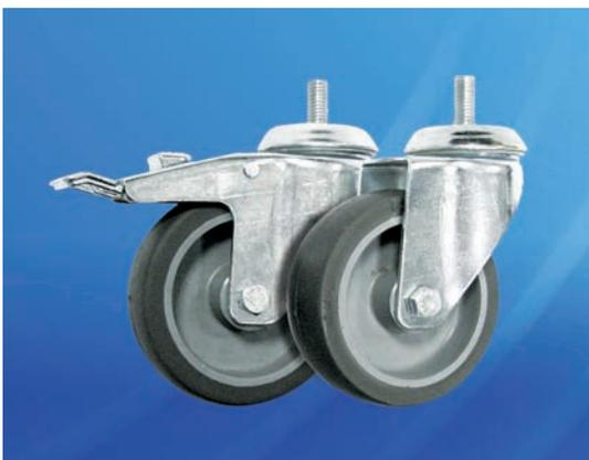
Предназначен для удобства перемещения, легко монтируется в стальные закладные рамы, диаметр резьбы 12 мм. Предельно допустимая статическая нагрузка 100 кг на ролик. Зазор от пола 125 мм
