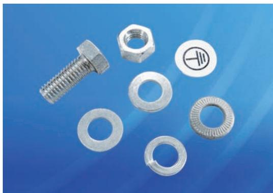
Предназначен для правильного заземления всех элементов корпуса, а также кабелей к раме шкафа. Зубчатые контактные шайбы обеспечивают надежное подсоединение кабеля заземления. Таким образом, отпадает необходимость удаления ЛКП вручную в области соединения
